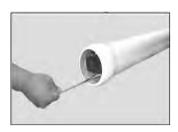
**Шаг 5** Демонтаж торцевой заглушки — Ниппель с наружной резьбой необходимо использовать для открытия торцевой заглушки. Ввинтите ниппель в отверстие подачи концентрата торцевой заглушки, слегка подвигайте ниппелем в стороны, и затем плавно вытяните ниппель из корпуса. При необходимости, крепко потяните для разъединения кольцевого уплотнения торцевой заглушки.
